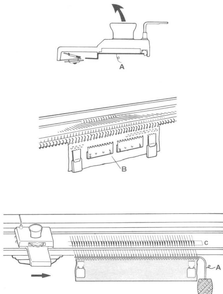
Если каретка «интарсия» застряла в процессе вязания, поднимите каретку вверх, держа ее за ручку каретки, и снимите с фонтуры. Рис.А.
